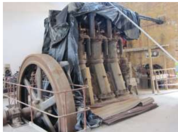
Figura 3. Grupo diesel Winterthur da central elétrica de Tomar (Fonte: Fundação EDP, 2019).
