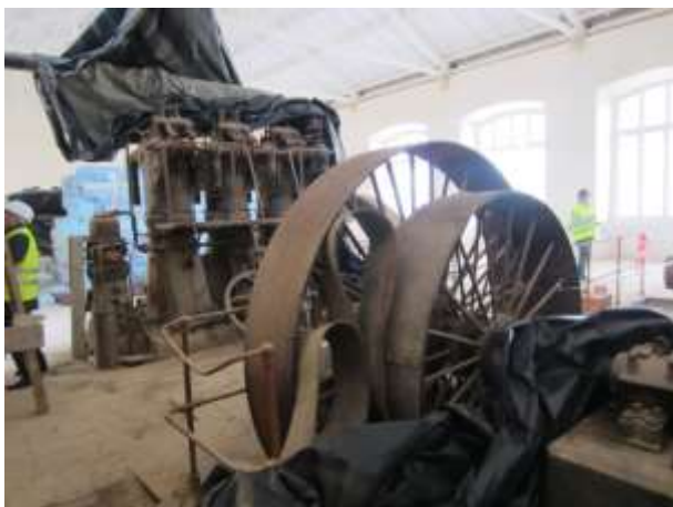
Figura 2. Grupo gerador hídrico Meyer da central elétrica de Tomar (Fonte: Fundação EDP, 2019).
