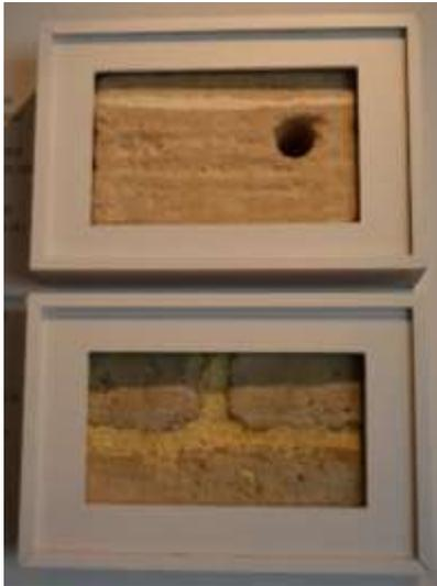
**Figura 2.** Exemplo de parede de taipa (imagem superior) e parede de adobe (imagem inferior)
